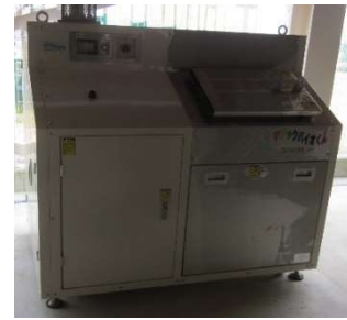
生ごみ処理機(平城中学校)
