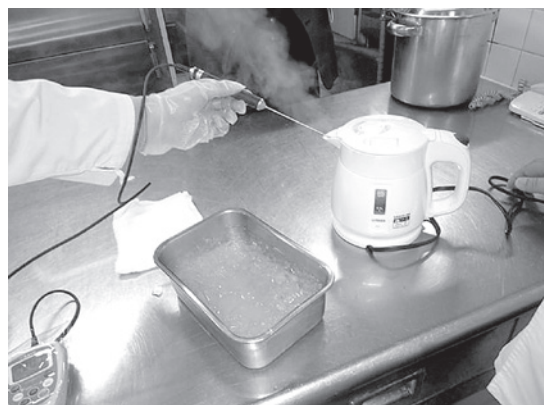
沸騰蒸気を使って中心温度計が100℃になることを確認
