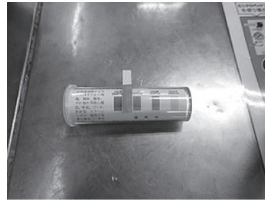
クロール試験紙で塩素濃度を確認できる
