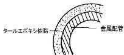
図3 防食塗料による塗装材の例
