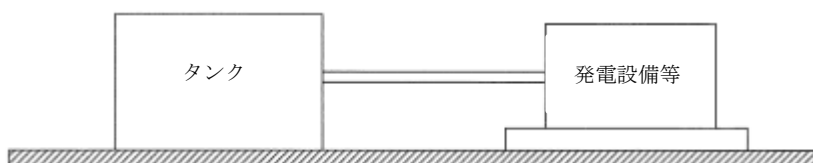
図3 タンクと設備が同一工程の場合の例
