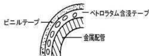
図5 防食テープによる覆装の例
